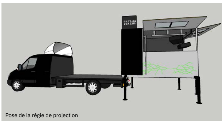
Véhicule roulant L.6m X l.2,15m X H.3,3m
